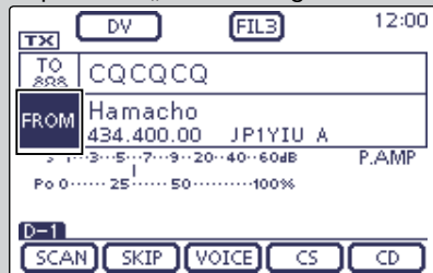
Repeater in „FROM“ eingestellt
